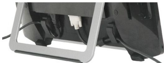
Una volta collegati tutti i cavi necessari a monitor e computer (vedere [Collegamento del monitor](#)) usare il passacavi per organizzare tutti i cavi come mostrato in alto.
